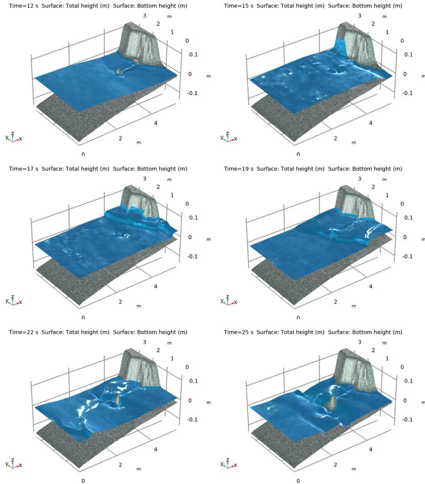
*Figure 3: Water level surface at  $t = 12$  s, 15 s, 17 s, 19 s, 22 s, and 25 s.*
